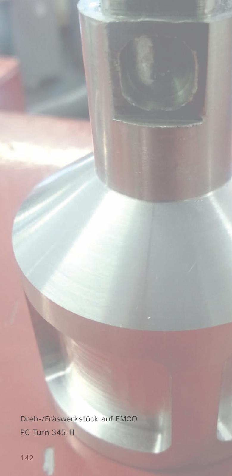
Dreh-/Fräswerkstück auf EMCO
