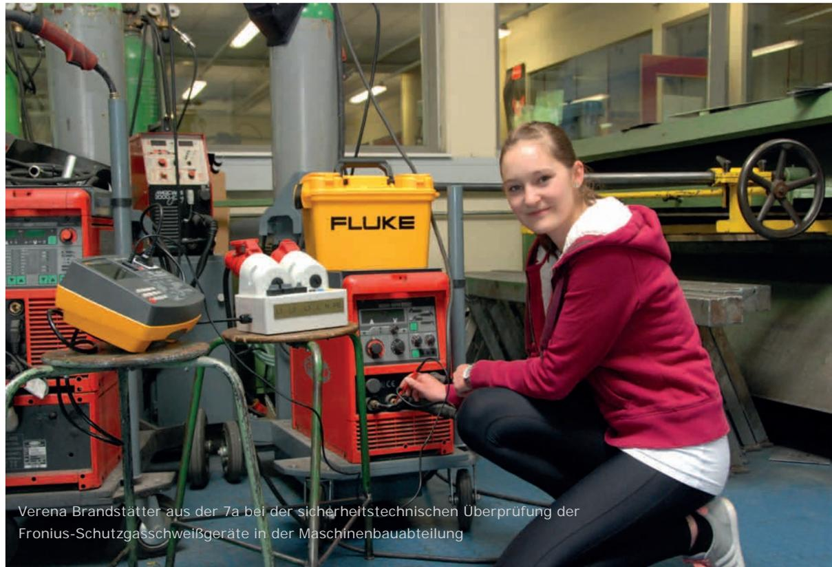
Verena Brandstätter aus der 7a bei der sicherheitstechnischen Überprüfung der Fronius-Schutzgasschweißgeräte in der Maschinenbauabteilung
