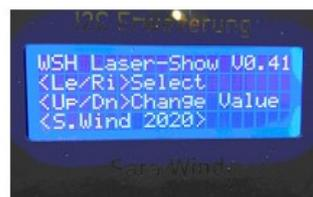
Angesteuert und programmiert wird die Laser-Show über die sog. **"WSH I<sup>2</sup>C Erweiterung"**, welche auf dem **"Arduino"** Open-Source-System basiert und zum Einstieg in die Mechatronik eine universelle Basis mit einer LCD-Anzeige, 5 Tasten 3 LED's und ein graphisch programmierbares OLED – Display enthält:
